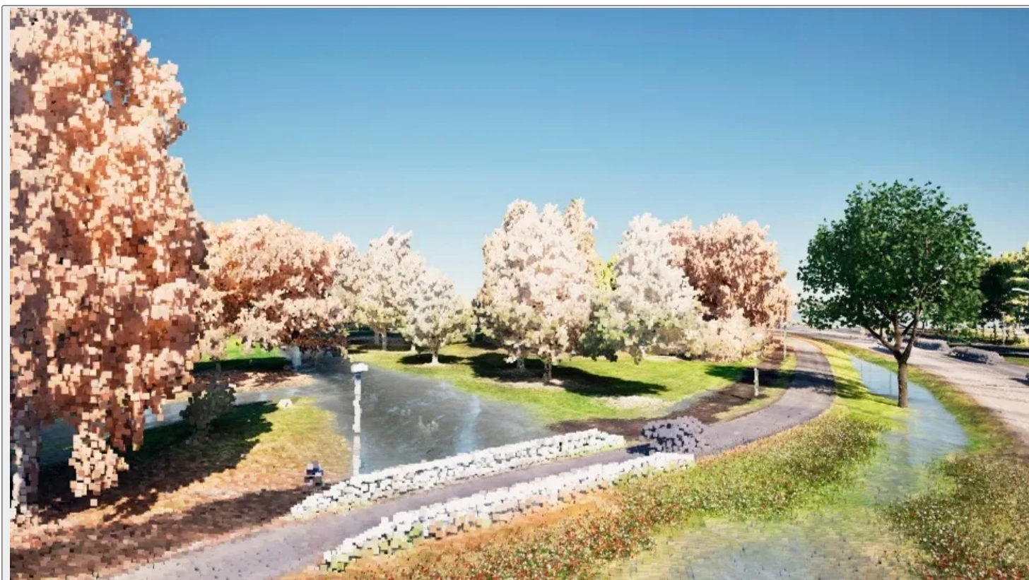
KUVA 8: Twinmotion on renderöinti- ja visualisointiohjelma. Ohjelmassa voi esimerkiksi lisätä kasvillisuutta tai tarkastella veden pinnan korkeutta. Tässä kuvassa pohjalla on pistepilvi ja välikaistalle on lisätty niittykasvillisuutta ja puu suoraan pistepilven päälle. Vedenpintaa on myös nostettu. Kuvakaappaus: Katja Virtanen / HAMK
