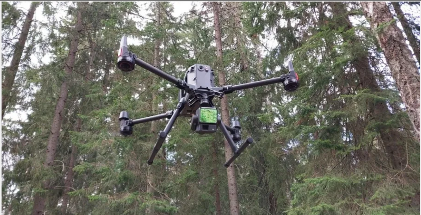
KUVA 2: DJI:n laserkeilain L2 on kiinnitetty droonin alapuolelle.
