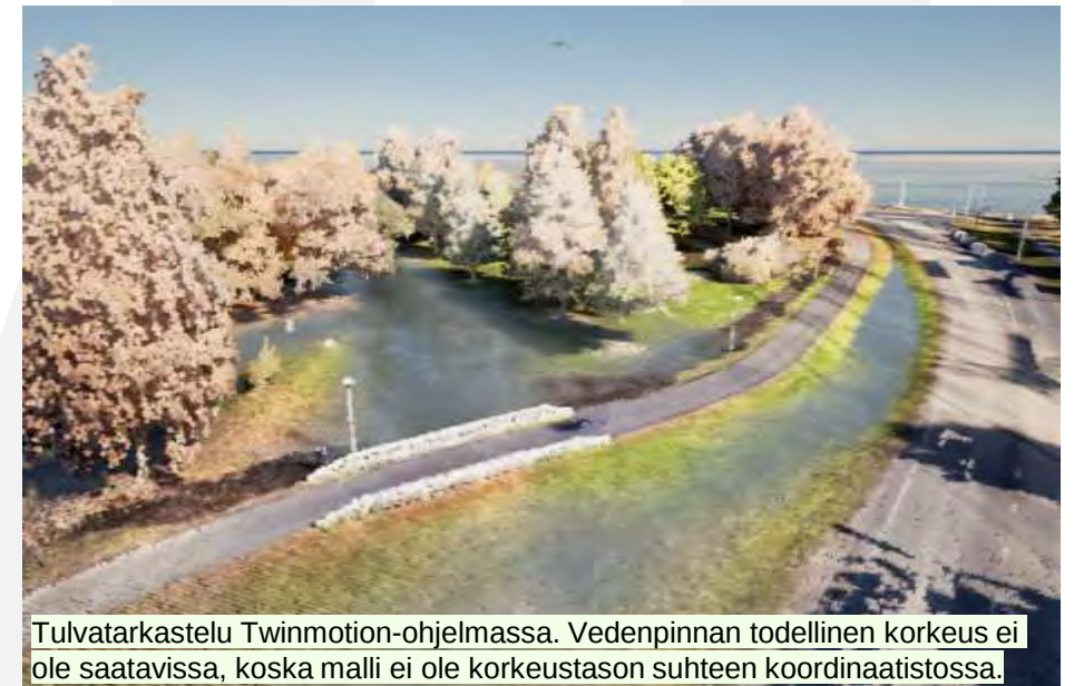
Palomiehenpuiston kenttäalueen puoleinen tulvatarkastelu (Vectorworks)
