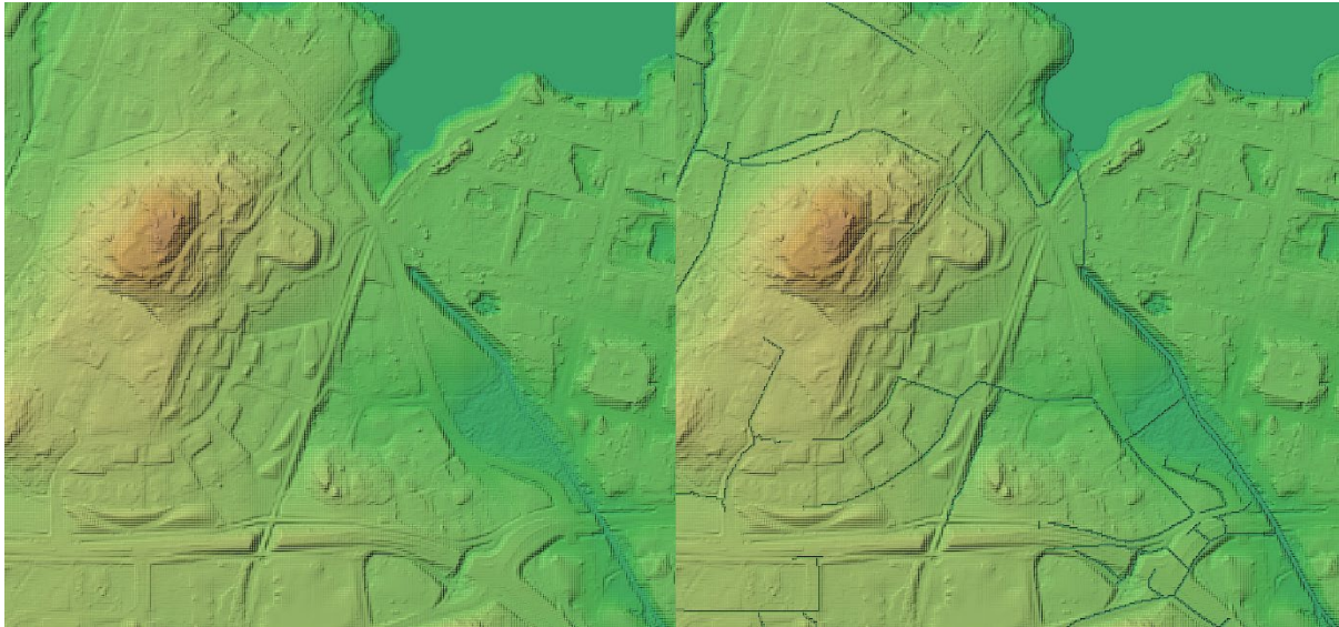
Kuva 35 Vasemmalla polttamaton ja oikealla poltetu korkeusmalli. Polttaminen näkyy korkeusmallissa selkeästi tummempina hiloina ja uomaverkosto on yhtenäisempi.
