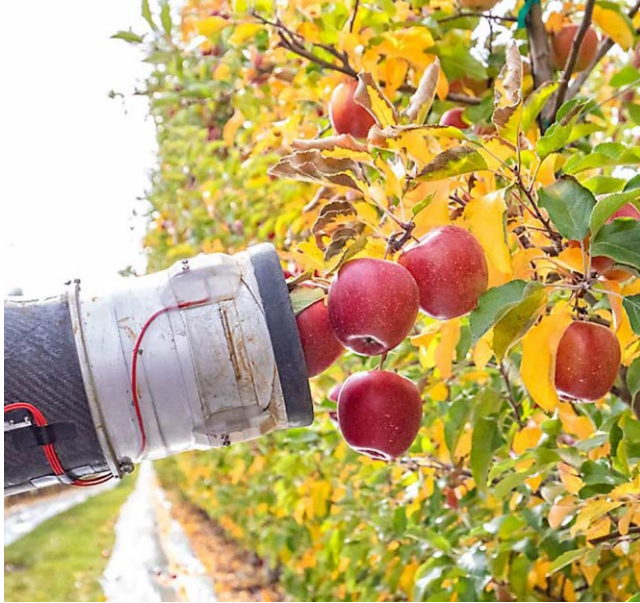
Kuva 16. Abundant Roboticsin kehittämä omenanpoimintarobotti poimii kypsät omenat imuimalla. Kuva: Good Fruit Grower.
