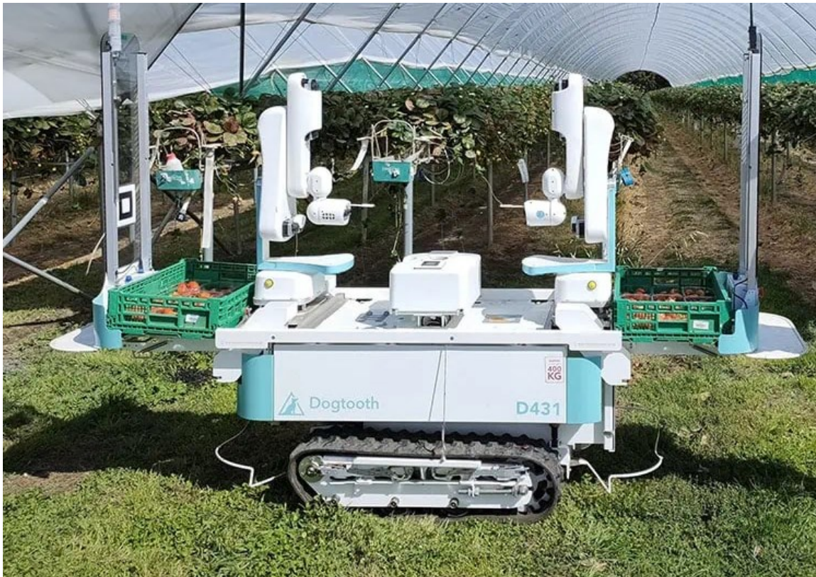
Kuva 11. Dogtoothin valmistama poimintarobotti. Robotin kummassakin päässä on poimintakourat ja keskellä on tarkistuskammio, jossa poimitun mansikan kunto tarkistetaan. Kuva: Dogtooth Technologies.
