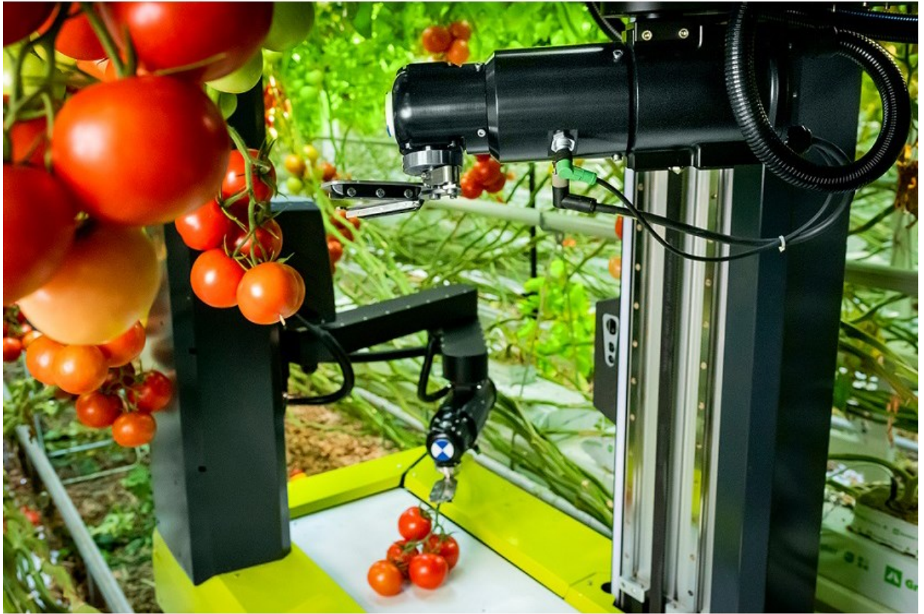
Kuva 5. GRoW-robotin poimintakoura siirtää poimitun tomaatin tertun robotissa olevalle liukuhihnalle. Liukuhihnaa pitkin terttu kuljetetaan laatikkoon. Kuva: Ridder/MetoMotion.
