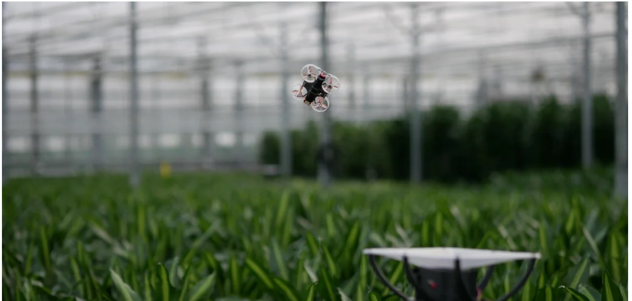
Kuva 23. Pats-X:n drooni, joka tuhoaa lentäviä kasvintuhoojia propelleillaan. Kuva: Pats Indoor Drone Systems.
