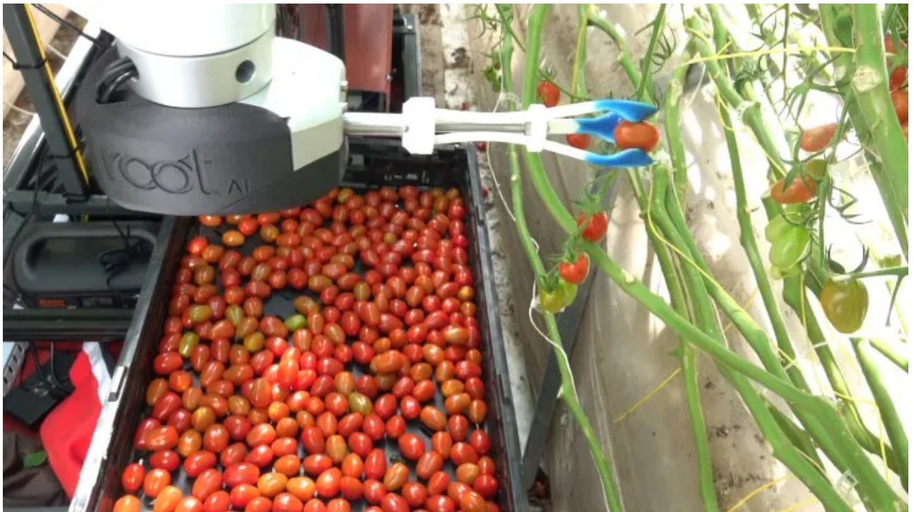
Kuva 7. Virgo-robotin poimintakoura. Tomaatti poimitaan pyöräyttämällä. Kuva: ROOT AI.
