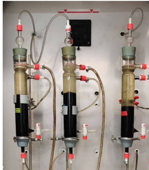
UASB-prosessi jätevesien ja nestemäisten syötteiden käsittelyyn
