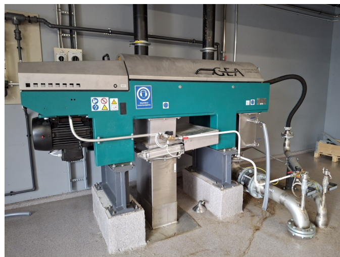
Kuva 3. Luke Jokioisten biokaasulaitoksen dekanterilinko, jolla separointikokeet tehtiin.
