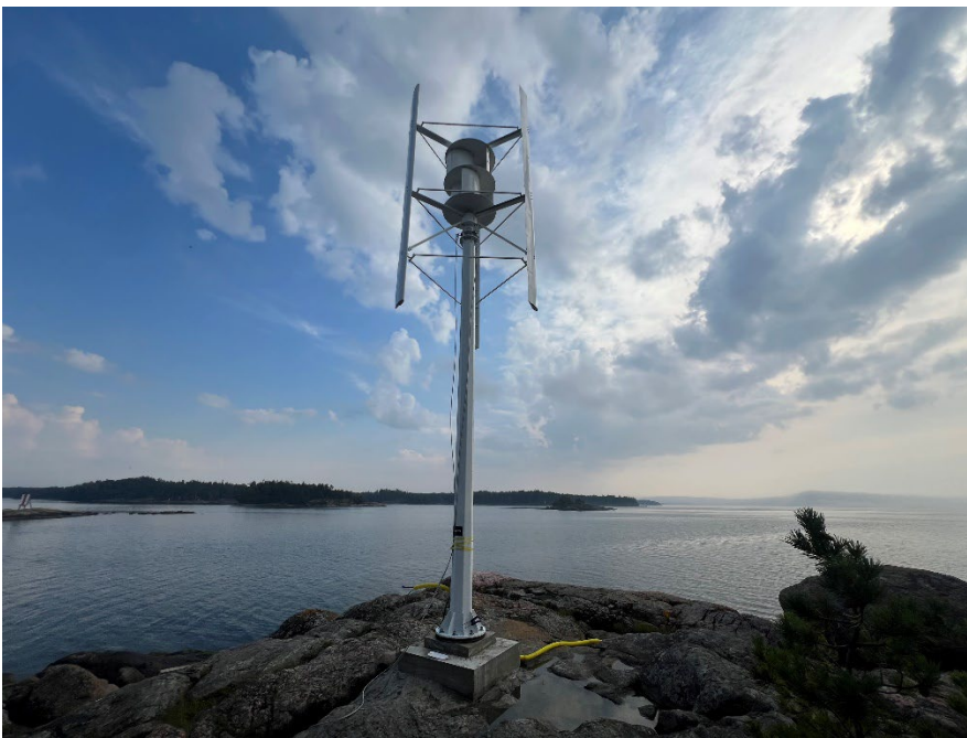
Kuva 2. SkyPower 5 kW vertikaali tuulivoimala asennetaan vakiona kahdeksan metriseen torniin (Vihreä Watti, n.d.).
