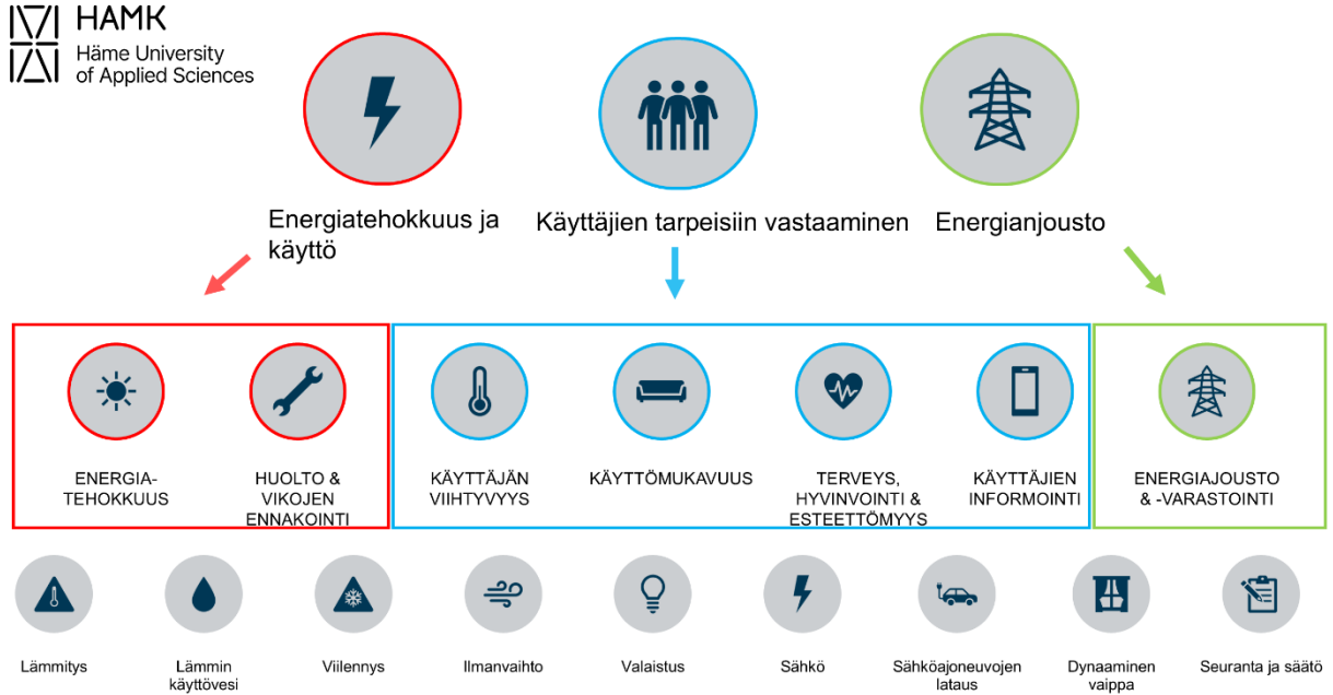
Kuva 1 SRI-viitekehys arvioi rakennuksen suorituskykyä kolmessa pääkategoriassa (energiatehokkuus, käyttäjälähtöisyys ja energiajoustavuus) yhdistäen tekniset järjestelmät keskeisiin vaikutuskriteereihin.
